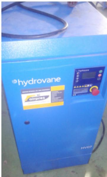
Incluye una serie de reactancia de línea y un filtro CEM integrado. El inversor de impulsión se adapta de forma eficiente el consumo de energía a la demanda de aire, y el sistema de ventilación de energía (REVS) también permite ahorrar energía. Este sistema suministra una intensidad de arranque baja y reduce la potencia en vacío al 25% mediante la purga de la presión interna.
