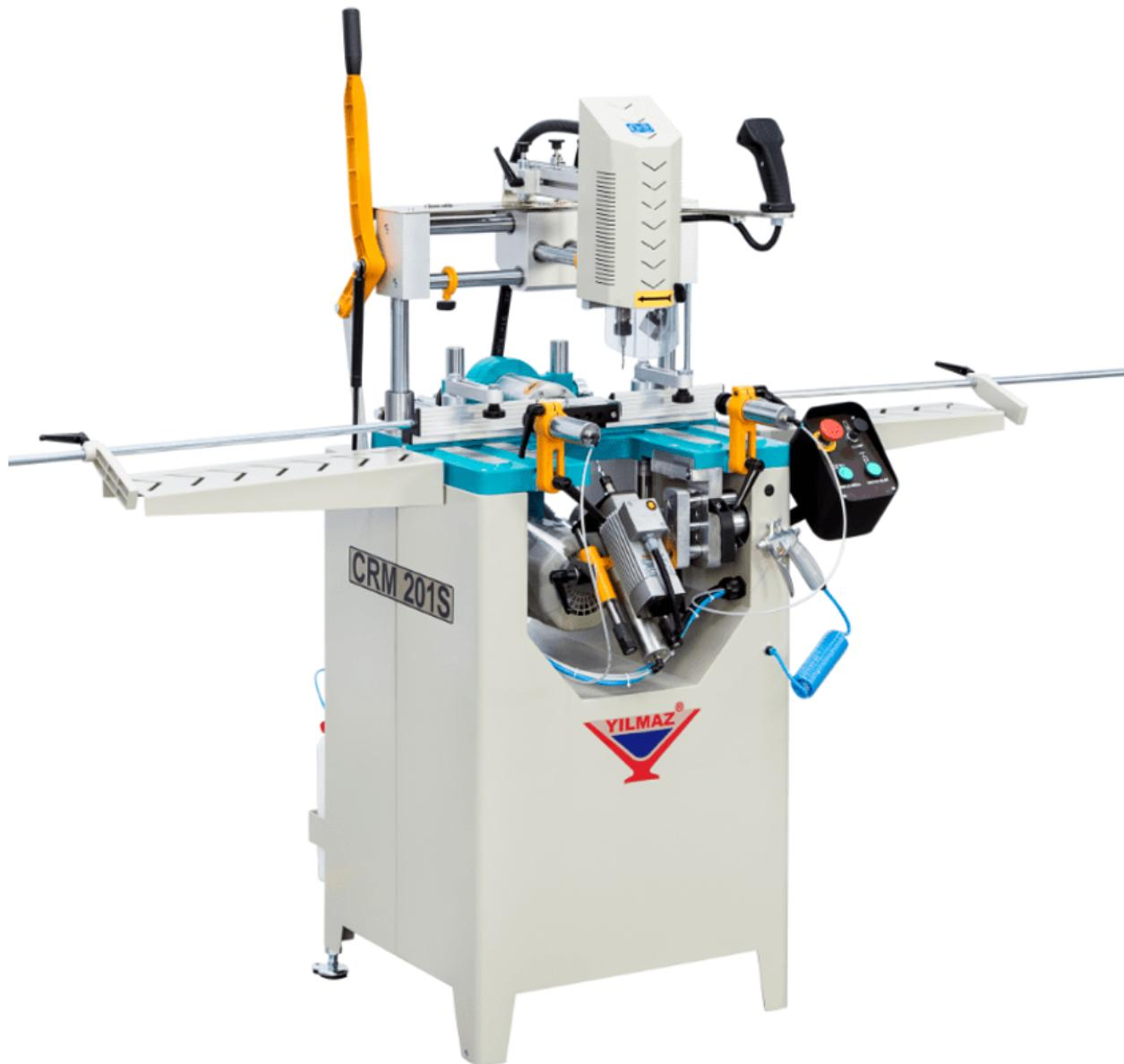
Copia, ajusta y opera manualmente. Las cifras de la plantilla se mecanizan en proporción 1: 1. Los perfiles de aluminio de hasta 3 mm pueden ser convenientemente mecanizados con un motor de giro.
