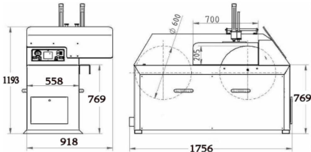
La máquina de corte lineal TRL esta especialmente diseñada para cortar perfiles de aluminio y paquetes de persianas de grandes dimensiones efectuando un corte limpio y preciso gracias al movimiento lineal del disco.
