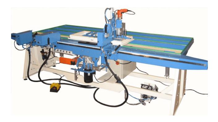
Banco de trabajo diseñado para realizar el mecanizado, montaje de herrajes, corte y atornillado de forma sencilla y rapida en aluminio, pvc y canal 16.
