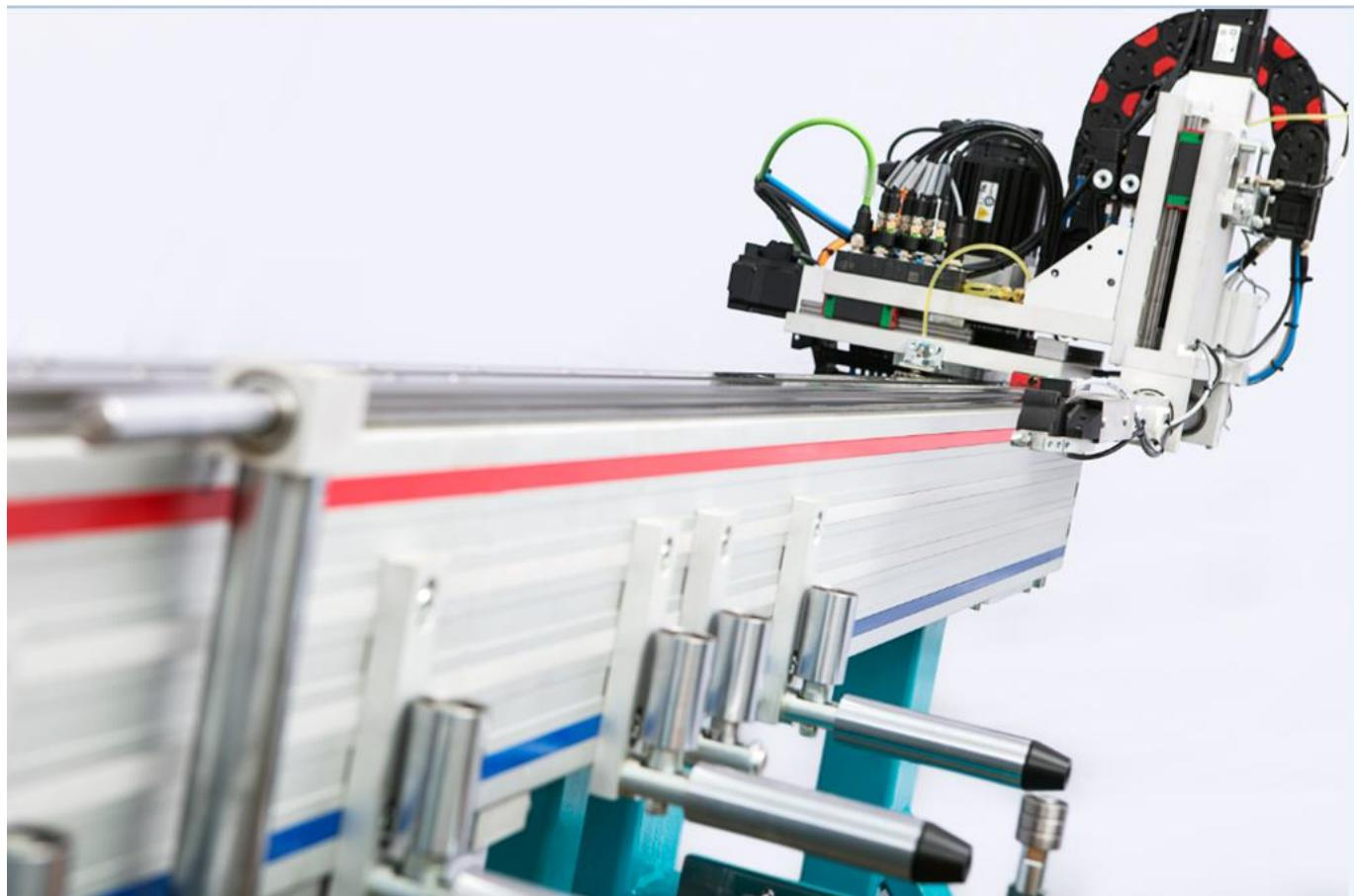
Máquina de 8 ejes con función de control servo y diseñada para el procesamiento de cualquier tipo de perfiles de PVC.
