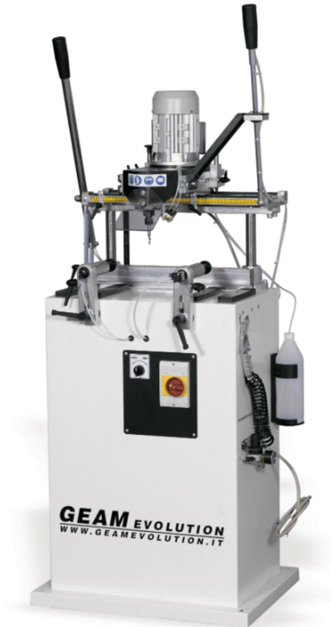
La copiadora fresadora manual Copy Ecos, está equipada con 2 prensos neumáticos, además de lubricación neumática así como 2 palpadores.
