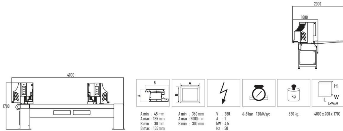
Soldadora específica para perfiles de PVC
