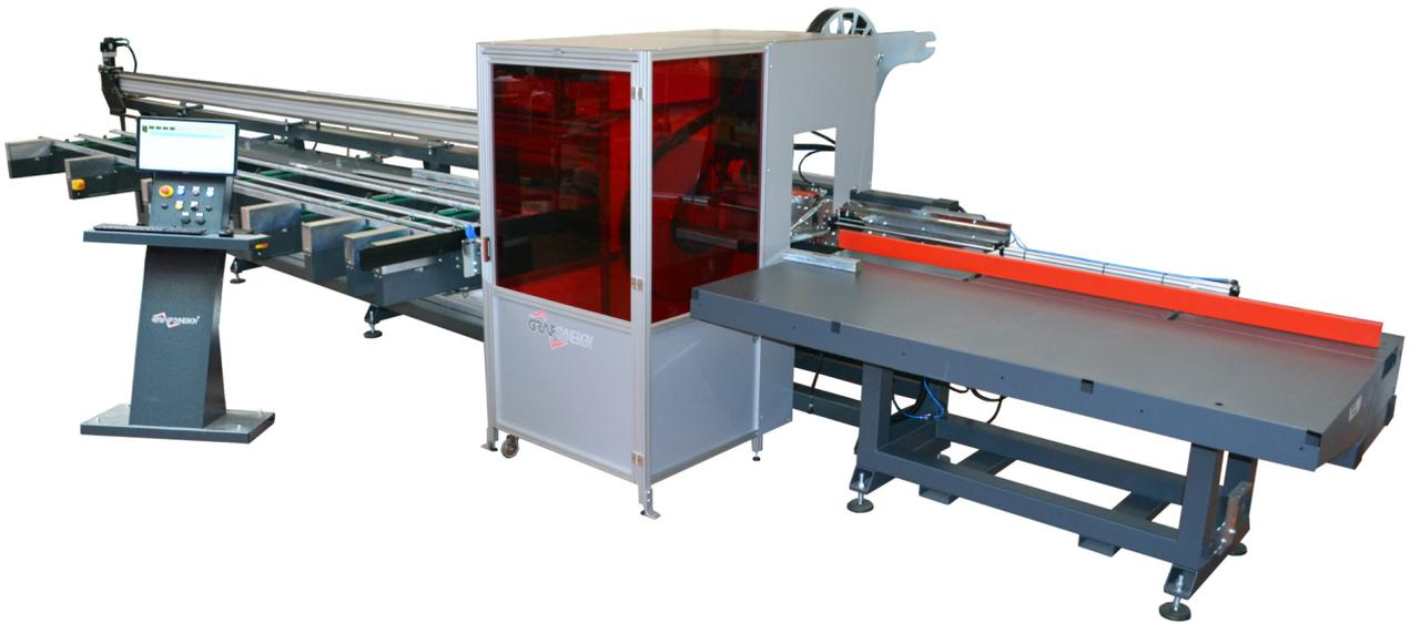
El PLASMA CUT de GRAF Synergy es un centro de corte y mecanizado automático para refuerzos que reduce los tiempos de ejecución con un corte eficiente gracias a su estructura de plasma rotativa de 4 ejes controlados por CNC y un potente software de gestión que trabaja con listas de corte y optimiza los procesos, minimizando el desperdicio de materiales.
