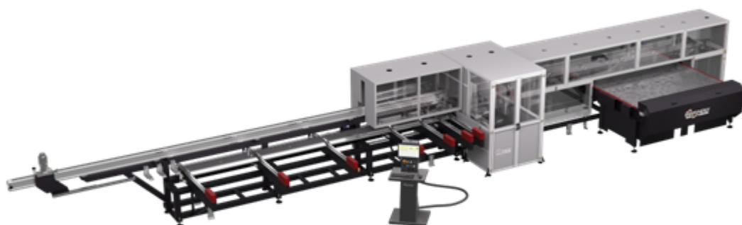
Revolucionario centro de corte para los refuerzos de acero de los perfiles de ventanas de PVC.
