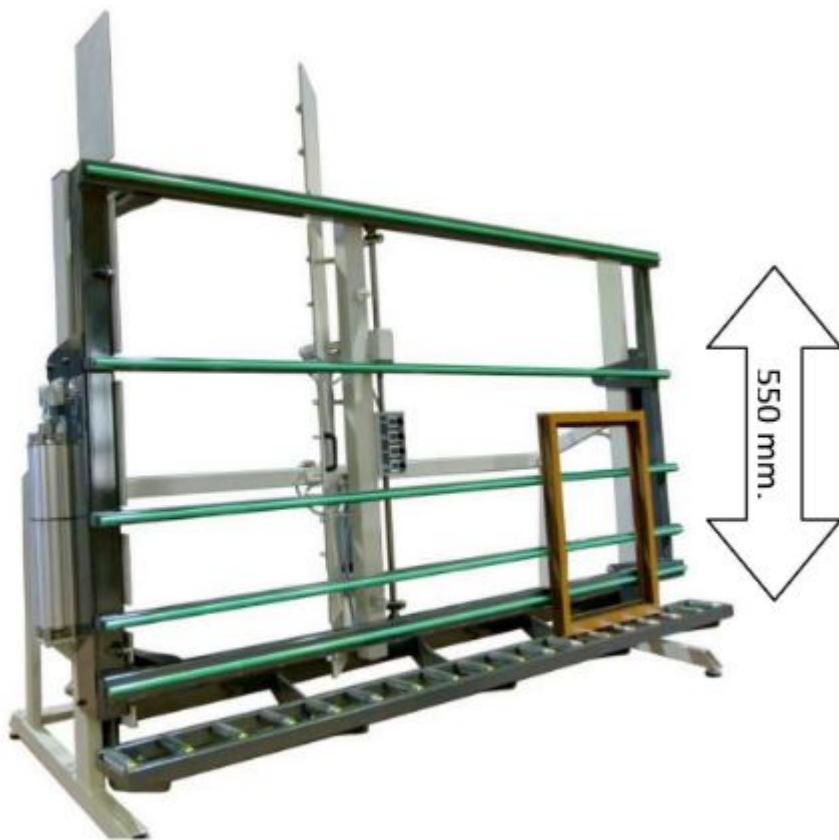
El modelo MAC 3000 de Strong Bull esta diseñado y fabricado para el montaje vertical del vidrio, es decir acristalamiento en carpintería de Aluminio y PVC. La mesa de acristalar MAC 3000 de Strong Bull permite acristalar ventanas de PVC, aluminio y madera.
