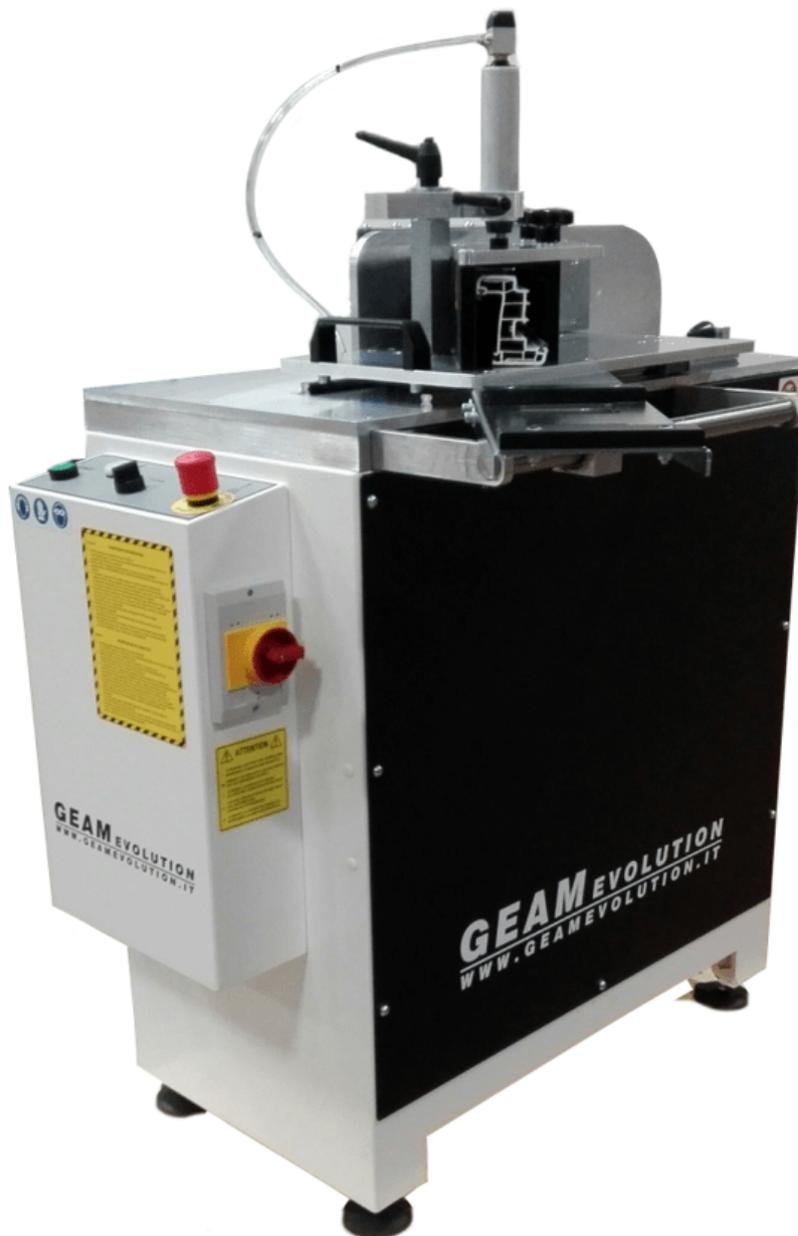
La Murena es una retestadora horizontal con avance manual para fresado a 45º especialmente diseñada para trabajar con perfiles con refuerzo de fibra de vidrio.
