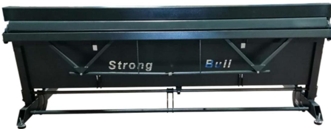
Plegadora manual diseñada esencialmente para el plegado de chapa de aluminio 1,2 mm.
