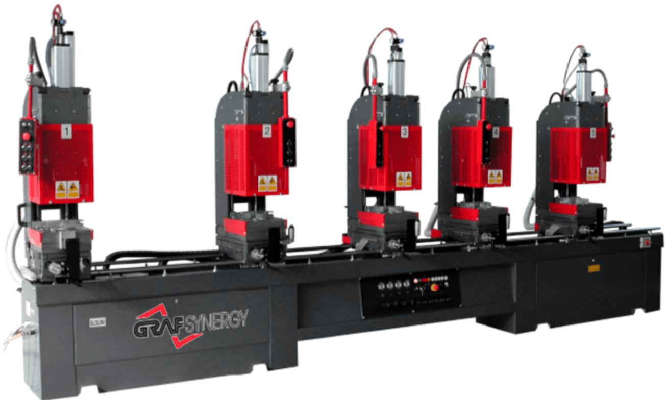
La SL5 U es una soldadora de 5 cabezales (3 universales y 2 universales rotativos), diseñada para soldar a cuña las vigas transversales gracias a la orientación y la alineación de los dos cabezales de soldadura.
