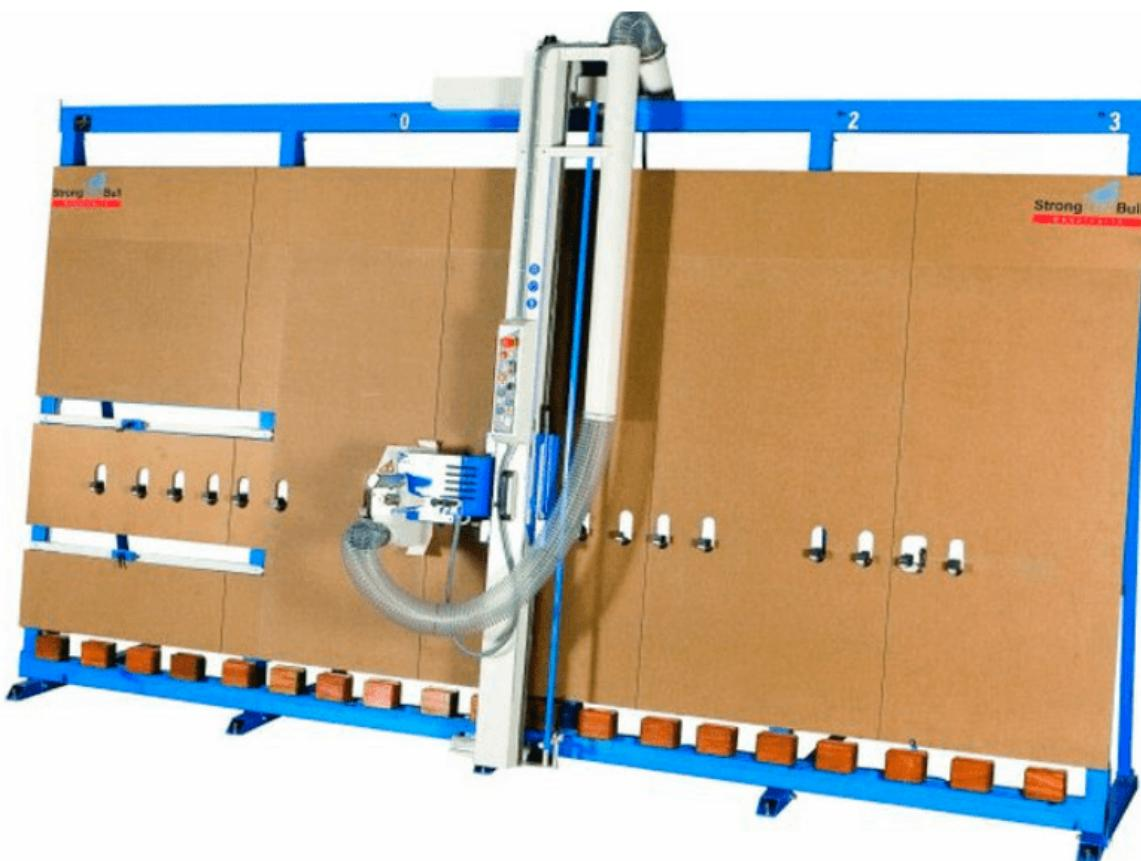
Diseñada especialmente para cortar y escuadrar paneles de sandwich, poli-carbonatos, metacrilato, madera, etc. con espesores hasta 90 mm.
